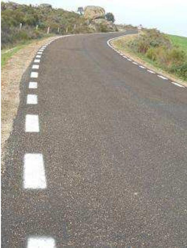
La superficie de la calzada con este material que se la ha puesto no es completamente lisa sino que presenta un granulado que favorece la adherencia de las ruedas al pavimento en caso de frenada o deslizamiento.
